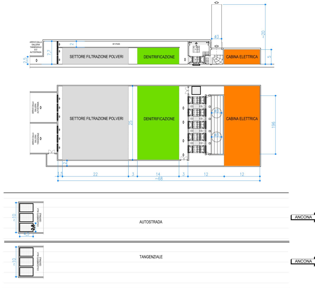
Figura 1-36 Schema centrale di filtrazione esterna
